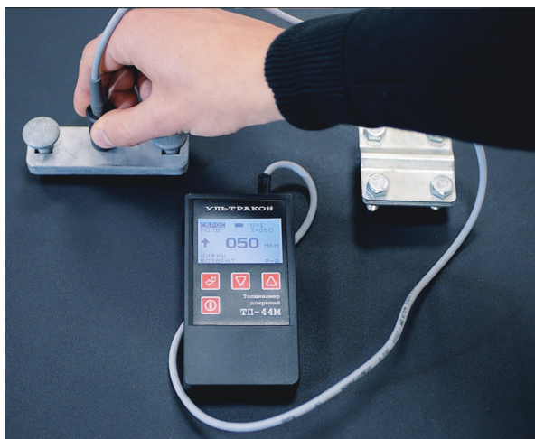
Товщина покриття пластин 50 мкм при методі гарячого цинкування
